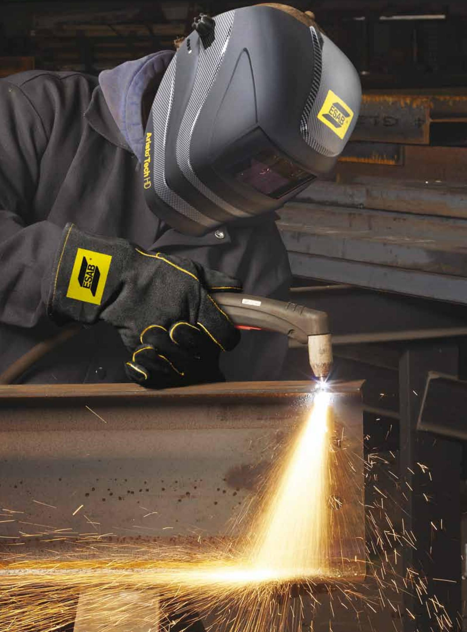
Il taglio plasma è un processo estremamente versatile di taglio per fusione per la gran parte dei metalli. Nel taglio plasma l'arco si sviluppa in una colonna altamente ionizzata di plasma tra un elettrodo che non fonde ed il pezzo da tagliare. La colonna viene concentrata mediante un ugello, dove la densità di potenza e la stabilità del flusso plasma vengono fortemente incrementate.
