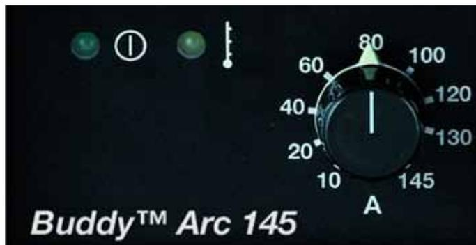
Buddy™ Arc 145 è molto semplice da usare. Basta una sola manopola per regolare la corrente di saldatura.
