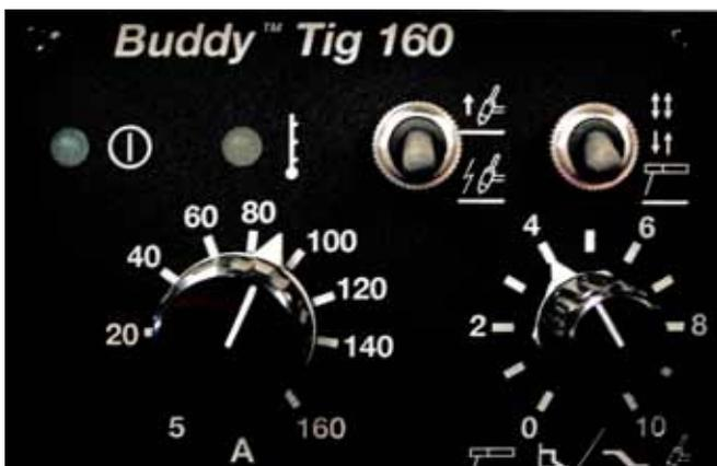
Il pannello di controllo della Buddy™ Tig 160 è dotato di una manopola per regolare la corrente di saldatura e di un'altra che regola il tempo della rampa di discesa in modalità TIG oppure l'intensità di Arc Force in modalità MMA.
