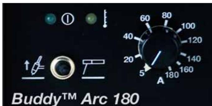
Buddy™ Arc 180 è dotata di una manopola per regolare la corrente di saldatura. Mediante un selettore si può passare da modalità MMA al procedimento TIG.
