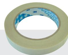
È un nastro autoadesivo con supporto in tessuto di vetro e adesivo silconico, adatto per l'utilizzo in presenza di alte temperature. Scotch™ 69 possiede il riconoscimento UL per funzionamento continuo a 200°C e UL 510 per il ritardo alla fiamma.
