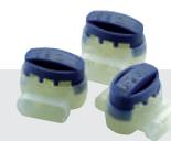
Connettori da 30 V fino a 600 V con corpo in Nylon ritardante la fiamma, consentono di terminare ed isolare 2/3 fili. Contengono olio minerale (EG3) che protegge da umidità ed acqua.
