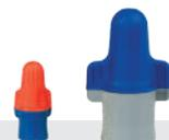
Connettori fino a 600 V che consentono la connessione di qualunque tipo di cavo per impianti elettrici. Il corpo isolante è ritardante la fiamma, le alette rendono facile girare il morsetto per ottenere la connessione. Molla in acciaio trattato per resistere alla corrosione.
