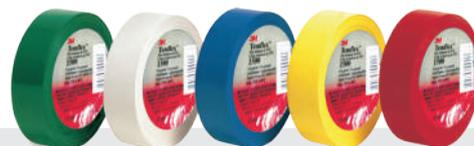
Nastro isolante autoadesivo ad uso generico in PVC autoestinguente. La sua affidabilità consente di risolvere problemi di isolamento elettrico e protezione in genere. La vasta gamma di colori permette di impiegarli per l'identificazione di cavi, tubi, etc. Temperatura d'esercizio tra -0° C e +90° C. Spessore: 0,15 mm. Approvazioni: CEI 15-15/VI-1980, VDE-340.
