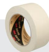
Nastro speciale in carta crespada di colore bianco, spessore 0,15 mm. Adesione N/cm 3,20. Carico di rottura 31,20 N/cm. Ideale per mascherature generiche per settori industriali con essiccamento a temperatura fino a 70°. Indicato per mascherature di paraurti in polipropilene. Adesivo in gomma resina naturale reticolata.
