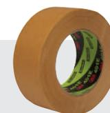
Nastro in carta crespada di colore bianco, spessore 0,17 mm. Adesione N/cm 4,00. Carico di rottura 40,00 N/cm. Per mascheratura industriale e nel settore automobilistico a media/alta temperatura (140°C), con cicli di asciugatura a forno prolungati o ripetuti. Adesivo in gomma resina.
