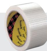
Nastro in polipropilene rinforzato con fibre di vetro tramato. Trasparente, spessore 145 micron. Adesione N/cm 8,00. Carico di rottura 300,00 N/cm. Allungamento % 10. Ideale per chiusura di scatole pesanti, unire imballaggi per la movimentazione di prodotto su bancale all'interno del magazzino. Facilmente rimovibile. Temperatura ambiente, adesivo Hot Melt solvent free.
