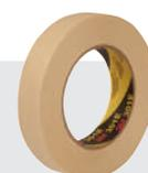
Nastro in carta crespada di colore bianco, spessore 0,15 mm. Adesione N/cm 3,60. Carico di rottura 38,00 N/cm. Per mascheratura industriale a media temperatura, buona linea di verniciatura, buona prevenzione al gocciolamento. Resiste alla temperatura max di 100° C. Adesivo in gomma resina.
