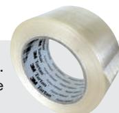
Nastro in polipropilene rinforzato con fibre di vetro unidirezionale. Trasparente, spessore 0,100 mm. Adesione N/cm 5,50. Carico di rottura 250,00 N/cm. Allungamento % 10. Ideale per chiusura di scatole, unire imballaggi per la movimentazione di prodotto su bancale all'interno del magazzino. Facilmente rimovibile. Temperatura ambiente, adesivo Hot Melt.
