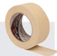
Nastro in carta crespada di colore bianco crema, spessore 0,125 mm. Adesione N/cm 2,80. Carico di rottura 31,20 N/cm. Ideale per mascherature nei settori industriali, edilizia e nel campo delle tinteggiature e verniciature, anche con essiccazione a forno. Resiste alla temperatura max di 60 °C per un'ora. Adesivo in gomma resina reticolata.
