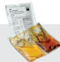
Resina in Polibutadiene bicomponente a stato finale morbido riaccessibile, formulata per sigillatura e isolamento elettrico fino a 1kV. Eccellente resistenza all'acqua per la posa in condizioni di esposizione costante di acqua. Bassa viscosità per un riempimento ideale annullando la possibilità di intrappolamenti di aria. Ha una temperatura di esercizio continuo di 90° C con picchi fino a 130° C.
