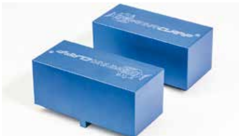
Codice : 551019 ALU L (170) Ganasce superiori in alluminio anodizzato Misure 50x98x61 mm/1,20 Kg Range di serraggio 0-160mm Codice : 551042 - Variante in acciaio
