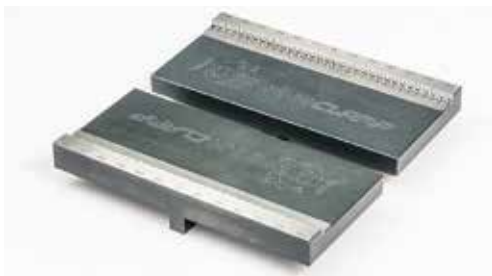
Codice : 551008 Ganasce zigrinate lunghe Misure 50x98x22 mm/0,90 Kg Range di serraggio 81-145 mm
