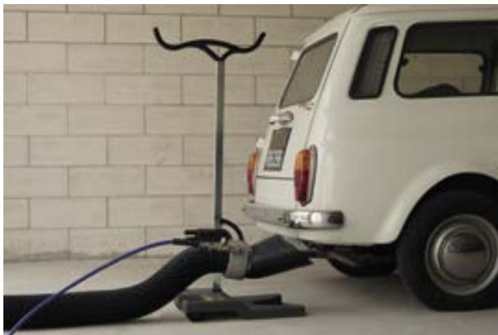
Aspiratore per gas di scarico di nuova concezione, alimentato ad aria compressa. Potenza di aspirazione regolabile. Un unico modello per autovetture, furgoni, motocicli, autocarri. Senza parti in movimento.
