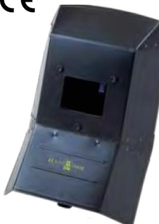
Curva con rinforzo, VULCAN è una maschera di protezione per usi professionali realizzata in FIBRA (vetri DIN 75 × 98 mm). Il sistema di fissaggio rapido dei vetri senza viti QUICK-GLASS tiene il vetro perfettamente fisso alla maschera (vedi descrizione per ELETTRA). È una maschera adatta a tutti i tipi di saldatura ad elettrodo e MIG/MAG.
