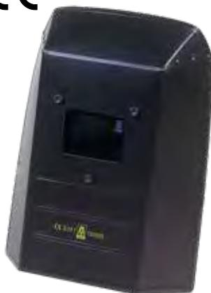
ELETTRA è una maschera di protezione realizzata in FIBRA (vetri DIN 75 × 98 mm). È la maschera più utilizzata con saldatrici di media taglia (fino a 250 A). L'esclusivo sistema di fissaggio RAPIDO dei vetri senza viti QUICK-GLASS tiene il vetro perfettamente fisso alla maschera. Fate la prova scuotendo un'altra maschera qualsiasi, sentirete il vetro battere nella sua sede. Nessun rivetto metallico! Condizione indispensabile perché la maschera sia a norma.
