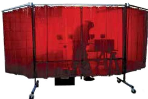
TRANSFLEX con ali laterali è un pannello mobile montato su ruote per la massima facilità di spostamento. Il telaio è in acciaio verniciato epoxy e lateralmente sono presenti due estensioni mobili che permettono di raggiungere i 3.7m di apertura. La tenda viene appesa al telaio tramite gli appositi ganci ad anello forniti. Il kit è molto facile da assemblare.
