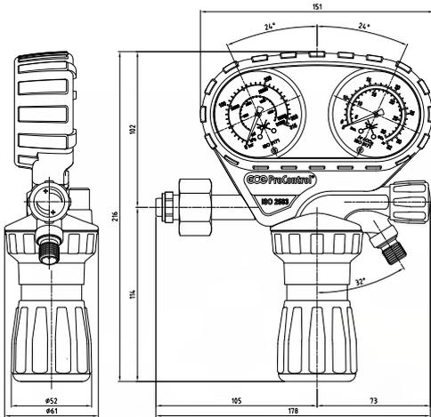
Misurazione accurata della pressione del gas. Facile lettura dei valori del gas impostati grazie a tre scale delle unità più utilizzate e un indicatore a contrasto.
