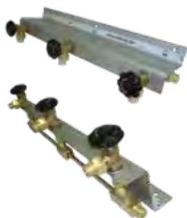
Le rampe a tre posti sono l'ideale per fissare a parete in modo stabile un riduttore forte erogazione ed avere 3 ingressi separati a cui collegare ad esempio 3 bombole per una buona autonomia di gas. Si può naturalmente collegare la rampa sia a un quadro di decompressione a uno o due ingressi tramite un tubo flessibile sia direttamente a un riduttore forte erogazione.
