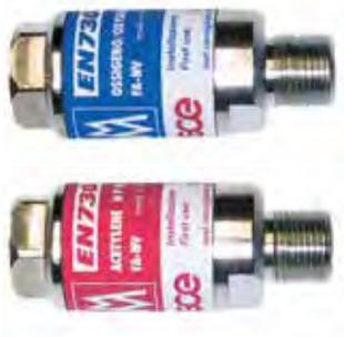
Le valvole di sicurezza MV93-RP sono prodotte da GCE secondo la norma EN730-1 e vanno applicate in uscita al riduttore di pressione (attacco 3/8"). Garantiscono la protezione totale contro i ritorni di fiamma (FA) e di gas (NV).
