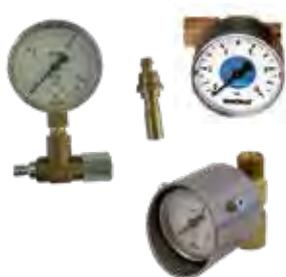
Si tratta di manometri da posizionare all'ingresso del cannello per verificare che la pressione che arriva al cannello stesso sia quella effettivamente corretta per il taglio da effettuare. Talvolta infatti il valore indicato dal riduttore potrebbe differire a causa di perdite di carico lungo il percorso (tubi strozzati o vecchi o valvole di sicurezza con filtri intasati dall'uso ecc).
