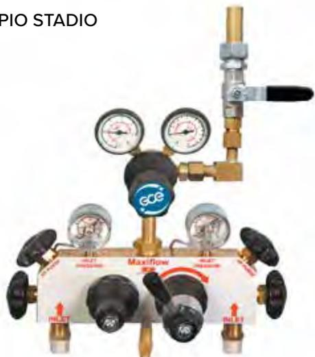
Quadro di decompressione a scambio automatico (riarmo manuale) per gas compressi (no acetilene) con pressioni fino a 300 bar. È possibile avere in opzione anche i manometri a contatto per ottenere il segnale a distanza di "gas in esaurimento".
