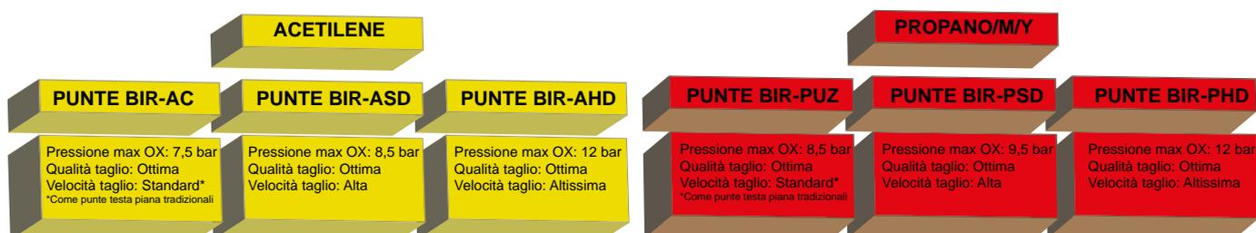
In generale tutti i pantografi presenti sul mercato permettono l'utilizzo sia delle punte standard che di quelle ad alta velocità in quanto la pressione dell'ossigeno di taglio necessaria (che è quella a fare la grande differenza sulla velocità) è inferiore ai 10 bar e normalmente i riduttori di pressione a bordo macchina e le valvole installate permettono di ottenere tale valore.
