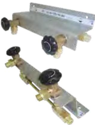
Le rampe a due posti sono l'ideale per fissare a parete in modo stabile un riduttore forte erogazione ed avere anche due ingressi separati con cui ottenere un sistema di riserva gas collegando (ad esempio) un pacco bombole all'ingresso 1 e una bombola all'ingresso 2 da attivare durante il cambio pacco non avendo così nessuna interruzione dei processi lavorativi. Si può naturalmente collegare la rampa anche a un quadro di decompressione a uno o due ingressi tramite un tubo flessibile.
