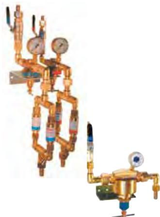
Si tratta della combinazione di una doppia postazione monoblocco di secondo stadio S100 (100m<sup>3</sup>/h) per quanto riguarda i gas OX+AC oppure OX+GPL destinati al riscaldamento (laddove una portata superiore ai 100 m<sup>3</sup>/h non servirebbe) con doppia valvola di sicurezza in uscita che aumenta la portata rispetto alla soluzione S100 standard.
