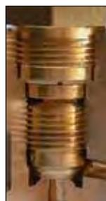
Dettaglio otturatore rotante
