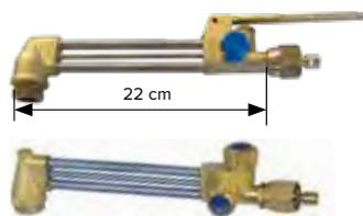
La miscelazione in punta garantisce la massima sicurezza in quanto viene ridotto praticamente a zero il percorso dei gas (combustibile e comburente) già miscelati insieme. La lancia è a leva o a rubinetto.
