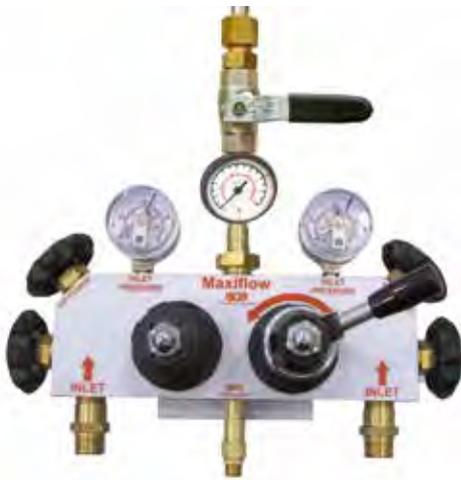
Quadro di decompressione a scambio automatico (riarmo manuale) per gas compressi (no acetilene) con pressioni fino a 300 bar. È possibile avere in opzione anche i manometri a contatto per ottenere il segnale a distanza di "gas esaurimento".
