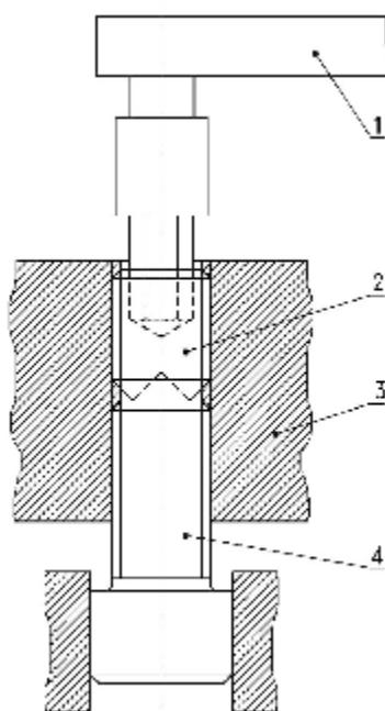
Usando un inserto chiave maschio esagonale con tolleranza h9 sull'apertura di chiave,  $s$ , dimensione sugli spigoli minima  $> 1,13 s_{min}$  e durezza da 55 HRC a 60 HRC, inserita completamente nella cava, la vite deve sopportare la coppia di prova indicata nel prospetto 5 senza incrinarsi o rompersi.
