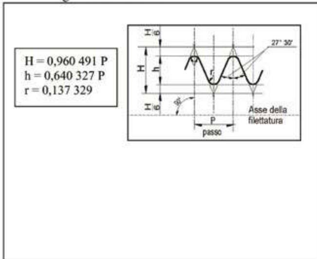
Fig.2 Filettatura Conica
